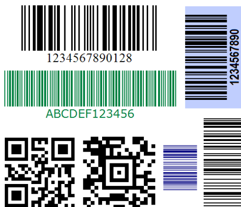
Figur 133. Exempel på olika streckkodsstandarder med olika inställningar såsom färg och typsnitt
